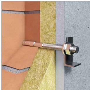
Крепление тяжёлых и эксплуатируемых элементов мебели к несущему основанию проводить при помощи анкерных болтов соответствующей длины в зависимости от материала основания. Крепление осуществлять через слои ГКЛ/ГВЛ и звукоизоляции к стене с заглублением в основание не менее 60 мм для тяжелых/плотных материалов: бетон, полнотелый кирпич.
