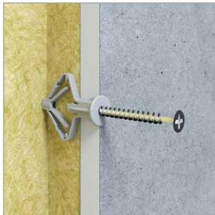
Крепление элементов мебели и декора к облицованной стене (весом не более 10 кг и выносом от стены не более 150 мм) проводить при помощи специального крепежа.
