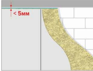
После нанесения клея-пены, осуществить монтаж облицовки в проектное положение. Корректировка проводится в течение первых 2-х минут. Монтажный зазор между листами ГКЛ/ГВЛ и стеной/потолком выполнятне более 5 мм. По завершении заполнить клеем-пеной.
