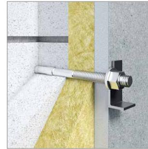
В несущем основании из лёгких/пористых материалов: газобетон, гипс, керамзитобетон, заглубление выполнять не менее 80 мм.
